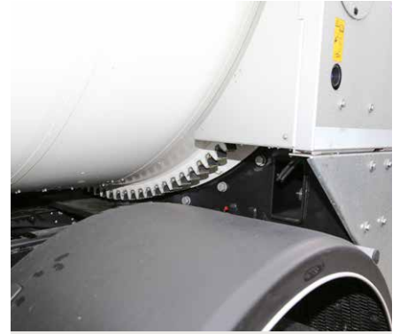
Bęben śmieciarki Rotopress jest napędzany silnikiem hydraulicznym przez przekładnię redukcyjną. To rozwiązanie proste, bezawaryjne, wymagające minimum obsługi.
