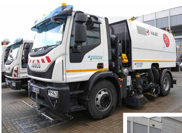
Zamiatarka Faun ViaJet 6 ma zbiornik na nieczystości, którego pojemność wynosi 6 m 3 , a także duży zapas wody – w dwóch zbiornikach wykonanych z włókna szklanego mieści się nawet 1900 l.
