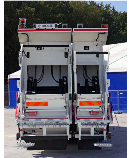
Dwuczęściowy odwłok z podwójnym wrzutnikiem pozwala na jednoczesny załadunek obu komór i rozładunek śmieciarki bez ryzyka wymieszania zgromadzonych odpadów – można podnieść tylko jedną część odwłoka.
