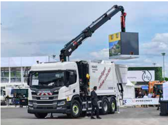
Kolejny innowacyjny pojazd na IFAT: hybrydowa Scania P 360 z zabudową typu X2 francuskiej produkcji, przystosowaną do opróżniania pojemników podnoszonych przez żuraw zakabinowy. W zastosowaniach komunalnych silnik spalinowy o mocy 360 KM, wspomagany przez elektryczny w krytycznych momentach ruszania z miejsca pod dużym obciążeniem, może zużywać nawet o 40% mniej paliwa niż w klasycznej śmieciarce.
