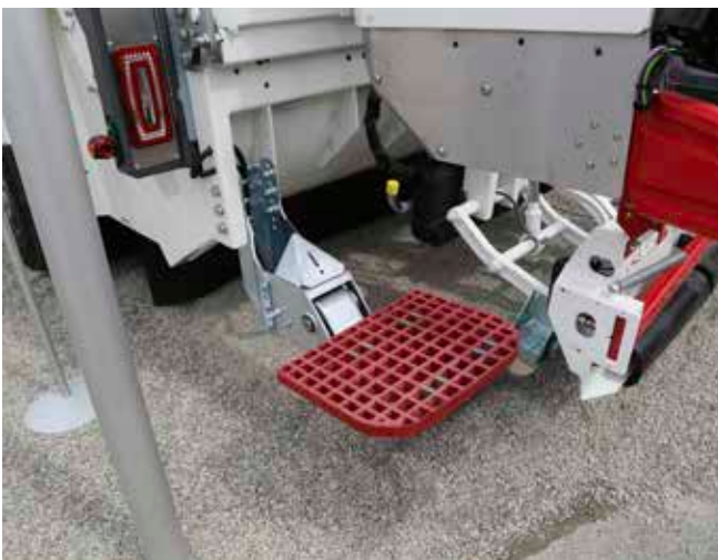
Stopnie dla ładowaczy w pojazdach z tylnym załadunkiem muszą mieć czujniki wymuszające ograniczenie prędkości jazdy i uniemożliwiające włączenie wstecznego biegu, jeśli wykryją obciążenie. Ponieważ wciąż dochodzi do wypadków, przewiduje się wprowadzenie stopni składanych i podnoszonych automatycznie, by dało się z nich korzystać dopiero po wciśnięciu osobnego przycisku.
