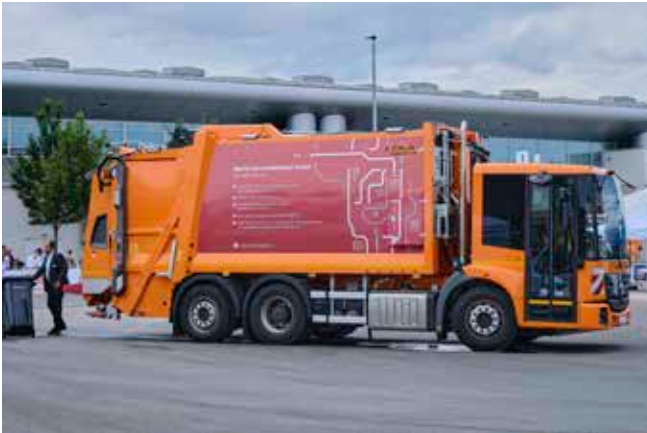
Zabudowa Medium X4H, podwyższona o 200 mm względem standardu, na pokazach zorganizowanych przez VAK (Verband der Arbeitsgerate-und Kommunalfahrzeug-Industrie, związek producentów maszyn roboczych i pojazdów komunalnych). Można dostrzec nowe położenie tylnej krawędzi skrzyni ładunkowej: tuż za tylną osią i bardziej pionowo niż w XL.
