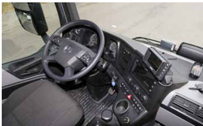
Niski profil tablicy rozdzielczej ułatwia obserwację obszaru przed pojazdem. Po prawej stronie został zamontowany dodatkowy monitor, który wyświetla obraz rejestrowany przez kamerę umieszczoną w górnej części odwłoka.
