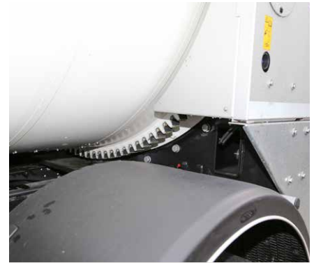
Bęben śmieciarki Rotopress jest napędzany silnikiem hydraulicznym przez przekładnię redukcijną. To rozwiązanie proste, bezawaryjne, wymagające minimum obsługi.
