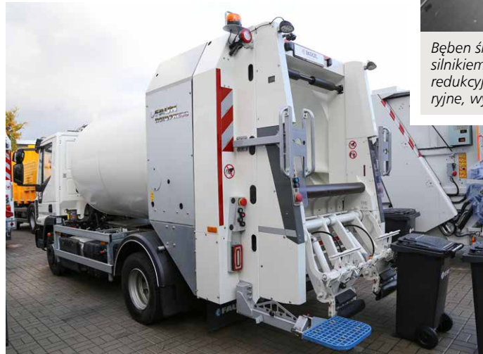
Odpowiednio dobrany układ zasypowy pozwala opróżnić wszystkie pojemniki o objętości od 60 do 1100 l.
