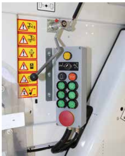
Do sterowania pracą zabudowy służy niewielki pulpit z dużymi przyciskami. Sam wrzutnik obsługuje się za pomocą ergonomicznej dźwigni zapewniającej wygodną obserwację ruchu pojemnika, bez narażania się na uderzenie ramienia urządzenia zasypowego.
