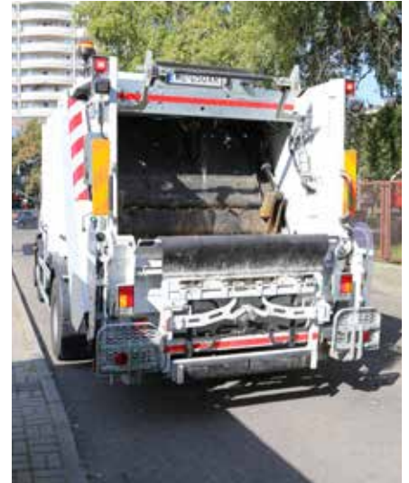
W przypadku urządzenia zasypowego SK 200 czas opróżniania pojemników o pojemności do 240 l wynosi ok. 8 s, większych – ok. 11 s.
