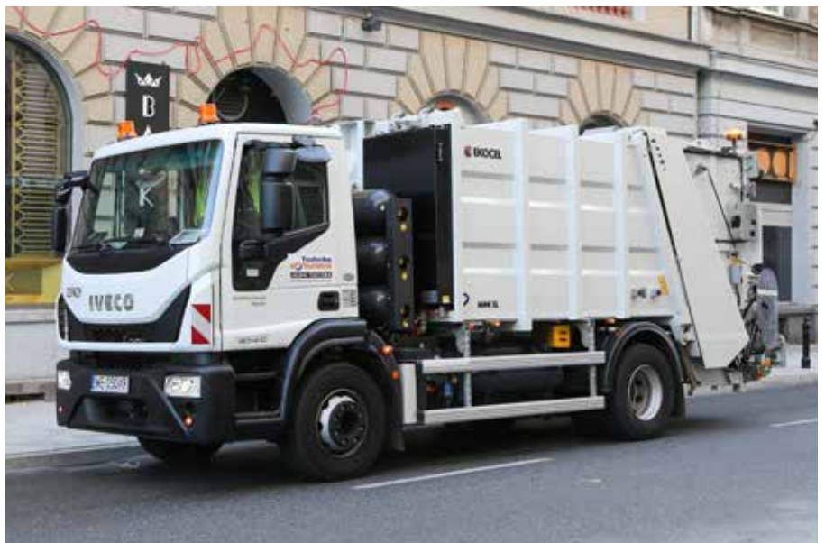
IVECO Eurocarga ML 160E21/P CNG może być homologowany na 16,8 t, więc zapewnia przepisową ładowność aż 5,5 t.
