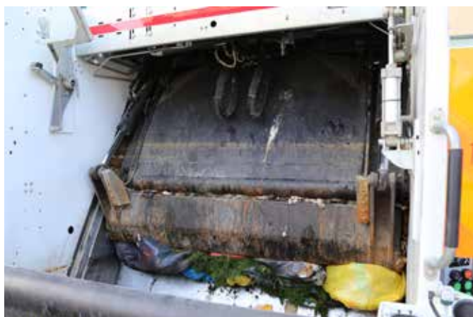
Siłowniki płyty zagęszczającej, która wygarnia odpady z wanny zasypowej, umieszczono po bokach na zewnątrz odwłoka, co gwarantuje sztywność konstrukcji oraz zwiększa ich trwałość.
