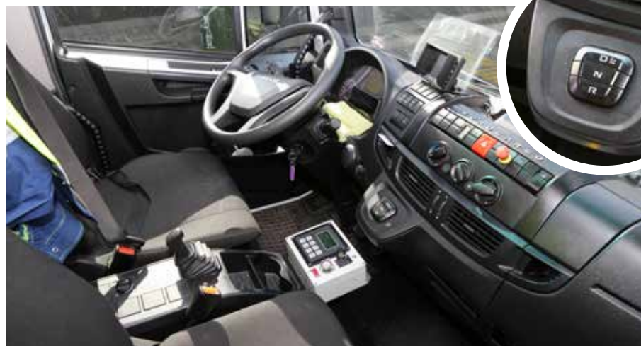
W wersji 3-osobowej konsola do obsługi automatycznej skrzyni biegów ma kompaktową budowę, dzięki czemu nie ogranicza przestrzeni środkowemu pasażerowi. Przytrzymanie przez dwie sekundy przycisku „D” powoduje włączenie „powolnego” trybu jazdy (pozwalającego na precyzyjne manewrowanie).
