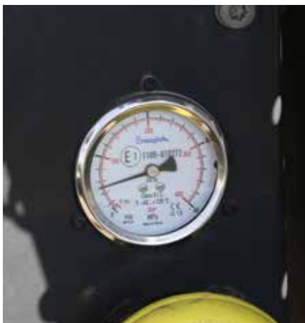
Wskaźnik ciśnienia zamontowany przy zaworze do tankowania pozwala na zorientowanie się co do poziomu gazu w zbiornikach. Takie rozwiązanie może być przydatne dla operatora floty, który bez otwierania pojazdu jest w stanie zdecydować czy wysłać śmieciarkę na rejon czy do stacji gazowej.
