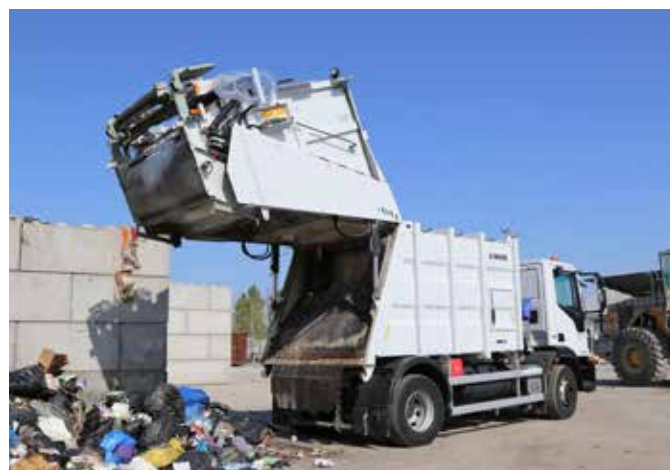
Po uniesieniu odwłoka realizowany jest automatycznie kompletny cykl mechanizmu prasy, aby usunąć z wanny zasypowej ewentualne resztki odpadów.
