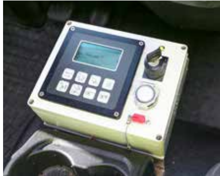
Terminal obsługi w kabinie kierowcy. Korzystając z niego można wybrać jeden z pięciu programów zbiórki odpadów, włączyć oświetlenie robocze i ostrzegawcze czy podnieść odwłok i uruchomić płytę wypychającą.
