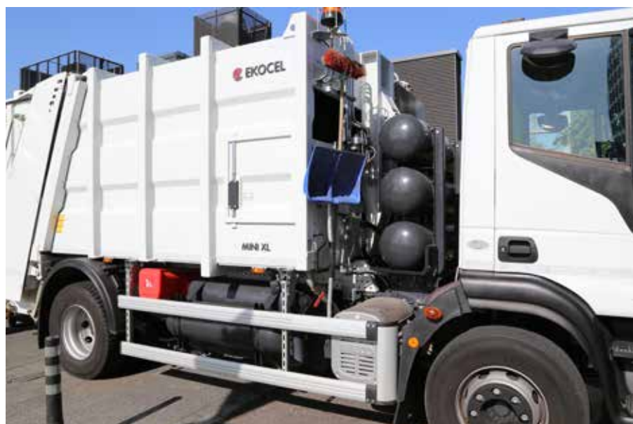
Tak wygląda konfiguracja zbiorników na CNG w wersji maksymalnej, czyli trzy butle za kabiną po 140 l każda i sześć z boku ramy – w dwóch pakietach 3x80 l. Razem daje to pojemność 900 l umożliwiającą zgromadzić zapas gazu wystarczający w przypadku śmieciarki nawet na 3-4 zmiany.
