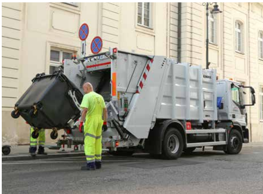
Zabudowa Mini XL spełnia wszystkie funkcje dużej śmieciarki, dzięki czemu można obsługiwać różne rodzaje pojemników od 110 do 1100 l.
