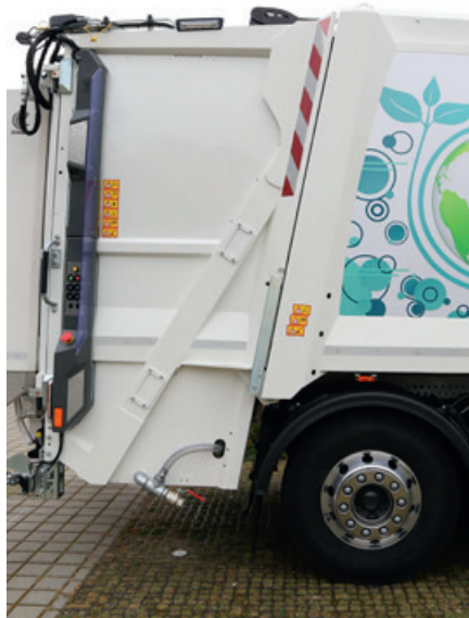
Skrzynia zabudowy Medium X4 jest „ścięta” z tyłu pod mniejszym kątem, zapewniając większą pojemność śmieciarki.
