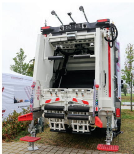
W zabudowie Medium X4 wszystkie siłowniki znajdują się wewnątrz odwłoka. W pełni automatyczne urządzenie ładunkowe DELTA 2301 ogranicza wysiłek operatora i znacznie przyspiesza pracę.
