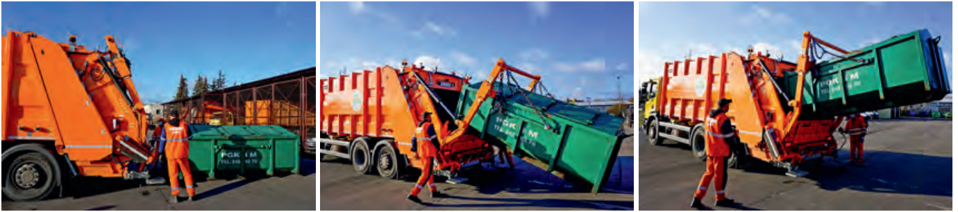
Do wyładunku kontenerów KP7 służy sterowany hydraulicznie portal. Chwytnie pojemników odbywa się w taki sam sposób, jak w przypadku bramowców. Rozwiązanie stosowane przez PGKiM zapewnia duże korzyści ekonomiczne, bo do jednej śmieciarki można opróżnić kilka kontenerów, a w przypadku systemu hakowego czy bramowego każdy pojemnik (ewentualnie dwa w przypadku zestawu przyczepowego) wymaga oddzielnego kursu.
